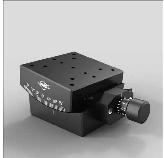
Die Goniometer GO 90 erlauben eine präzise Positionierung mit Hilfe eines Präzisionsschneckengetriebes und einer nachstellbaren Schwalbenschwanzführung von  $\pm 15^\circ$  um einen definierten optischen Punkt.
