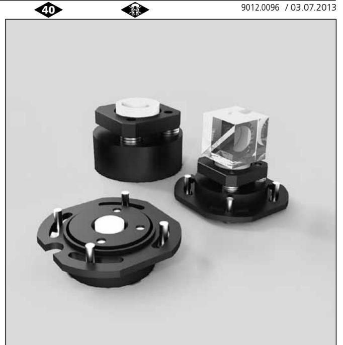
Mit den Justiereinsätzen JT 40T können diverse optische Elemente hochpräzise, erschütterungsfest und langzeitstabil justiert werden. Bewegliche Komponententräger werden dazu durch drei Schrauben mit Tellerfedern gegen eine Basisplatte verspannt.
